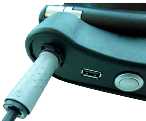
Illustration 5.2 : Connexion de la sonde
