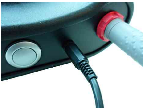
Illustration 5.4 : connexion du joystick
