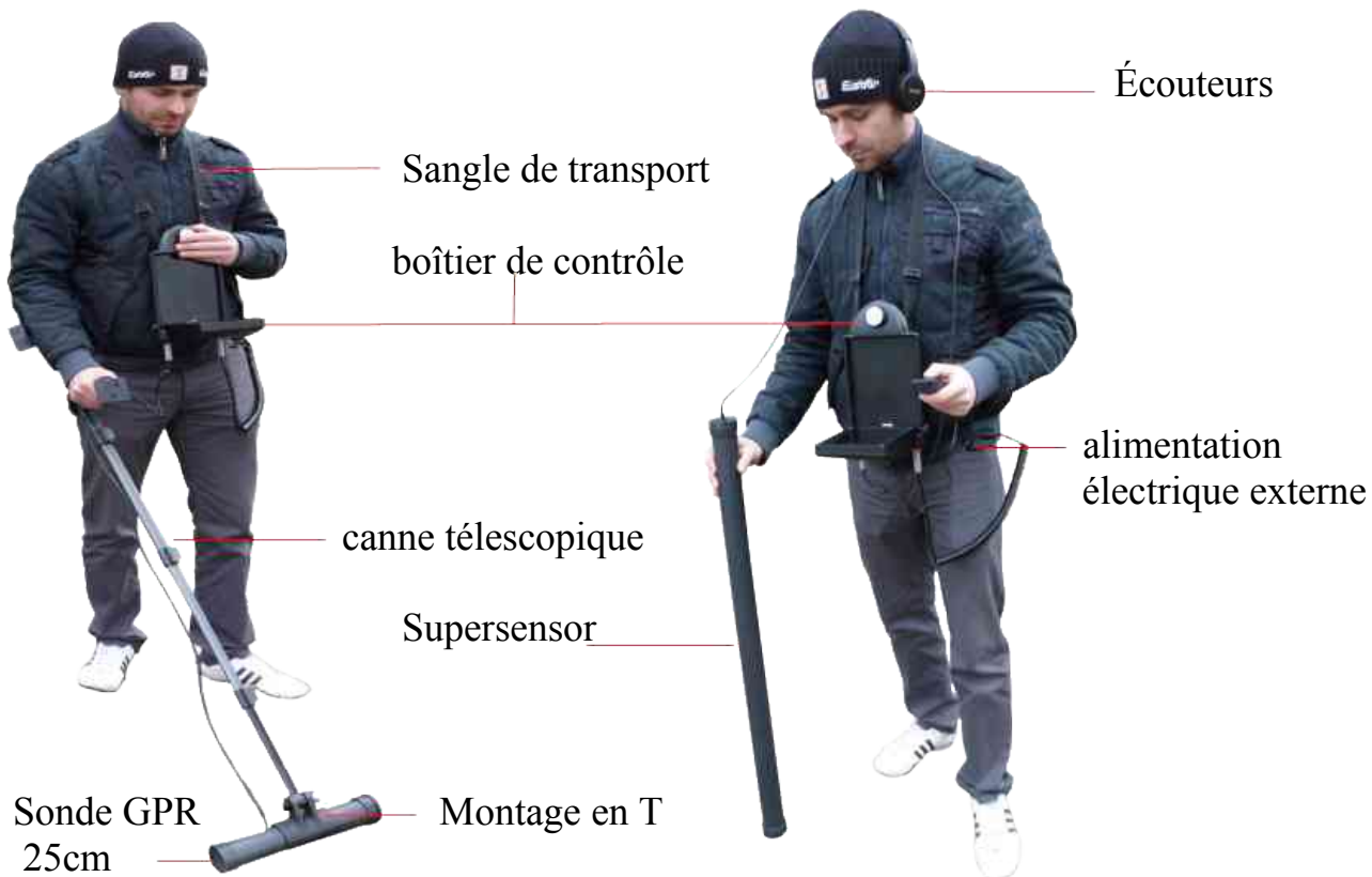
Illustration 6.1 : boîtier de contrôle avec une sonde GPR standard et super Sensor
