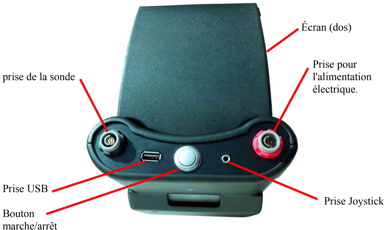
Illustration 6.3 : boîtier de contrôle, vue arrière
