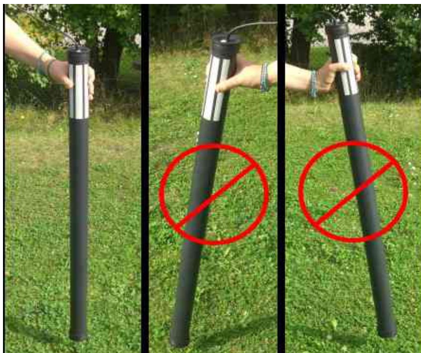
Illustration 9.3 : Orientation du Super Sensor
