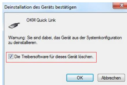
Abbildung 2.37: USB-Treiber in Windows 7 deinstallieren, Schritt 2
