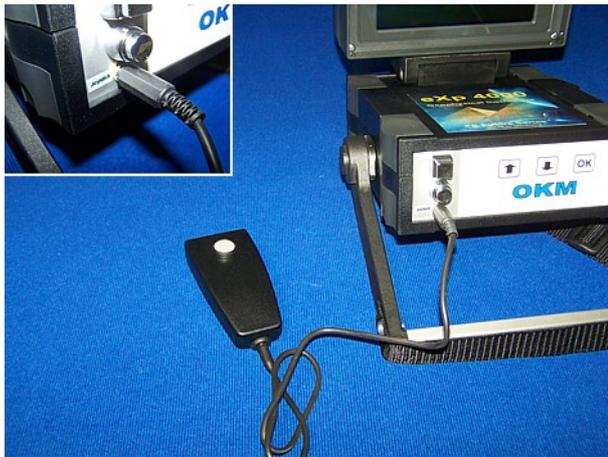
Abbildung 5.4: Anschluss des Joysticks
