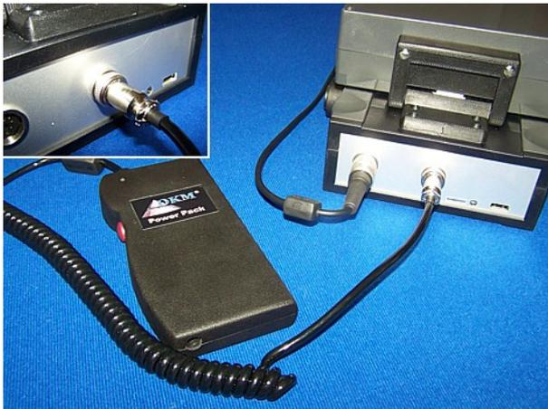
Abbildung 5.2: Anschluss des Power Packs
