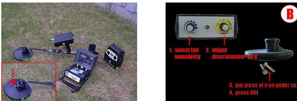
Abbildung 9.4: Kalibrierung des DDV-Systems, Schritt 2
