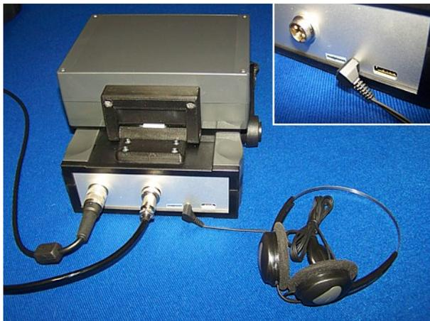
Abbildung 5.3: Anschluss des Kopfhörers
