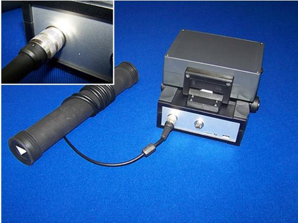
Abbildung 5.1: Anschluss der Sonde
