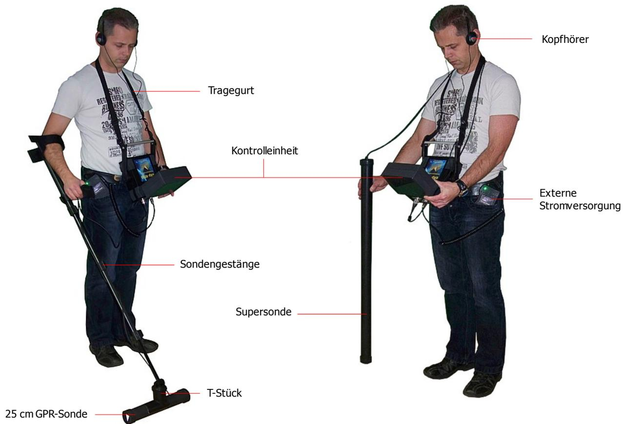
Abbildung 6.1: Kontrolleinheit mit Stromversorgung und Sonde
