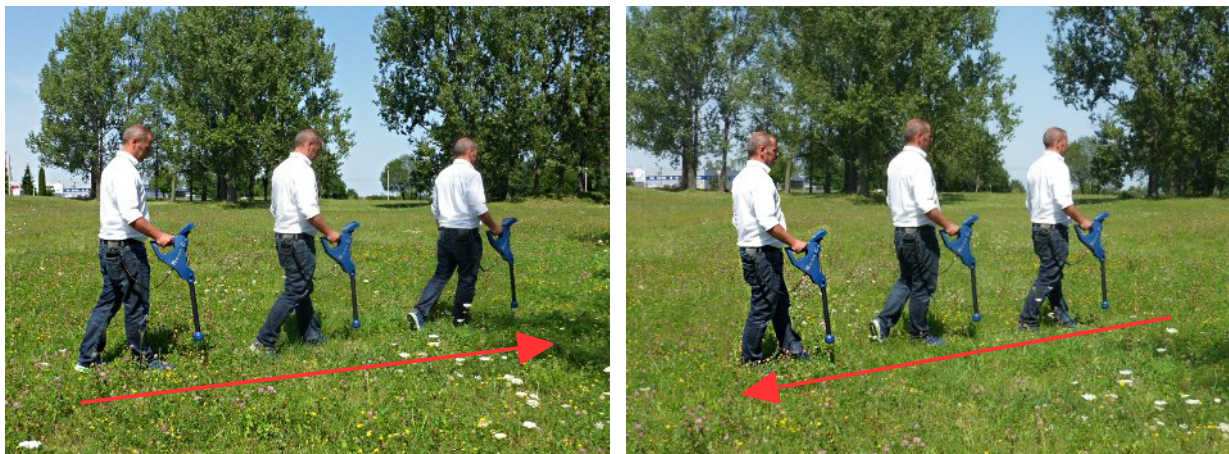
Figura 7.3: "zigzag" de exploración en el modo de exploración de la tierra
