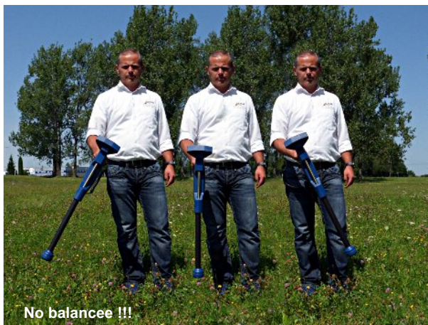
Figura 7.10: pivotante o de inflexi6n de la sonda falsifies la medici6n
