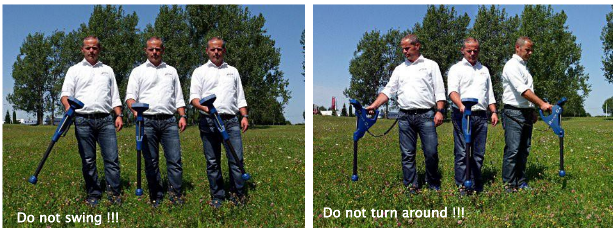
Figure 7.10: Pivotement ou rotation de la sonde falsifie la mesure
