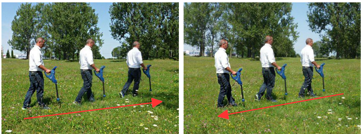
Figure 7.3: « Zig-Zag » numérisation en mode Ground Scan
