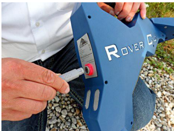
Figure 6.2: Connectez le bloc d'alimentation pour l'alimentation
