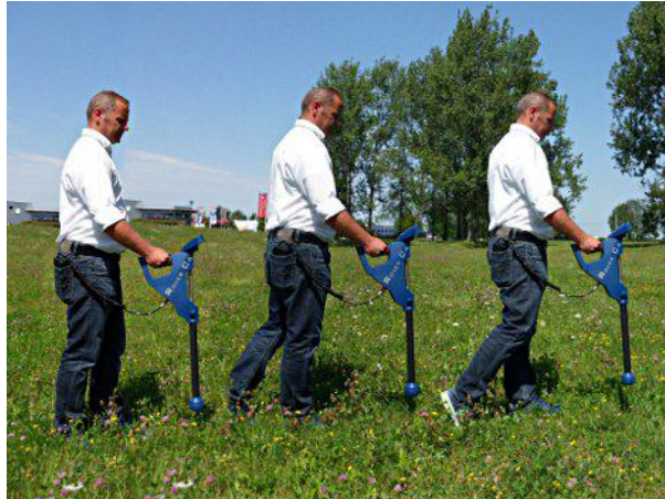
Figure 7.9: La sonde doit pointer toujours vers le bas et ne doit pas être tournée
