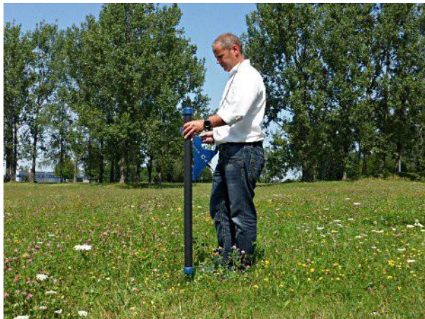
Figure 7.4: Position de la Super Sensor pendant une mesure
