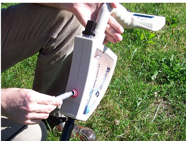
Abbildung 6.3: Power Pack zur Stromversorgung anschliessen
