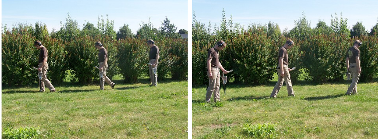
Abbildung 7.5: "Zig-Zag" Messung im Ground Scan
