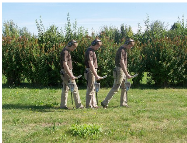
Abbildung 7.2: Sonde muss stets nach unten zeigen und darf nicht gedreht werden
