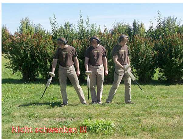
Abbildung 7.3: Das Schwenken und Drehen der Sonde verfälscht die Messungen
