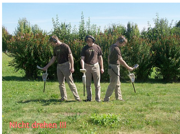
Abbildung 7.3: Das Schwenken und Drehen der Sonde verfälscht die Messungen
