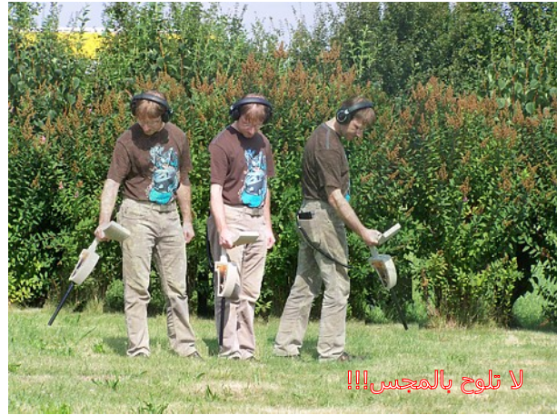
الرسم 7.3: التلويح بالمجس وتدويره يؤثران على صحة نتائج القياس.
