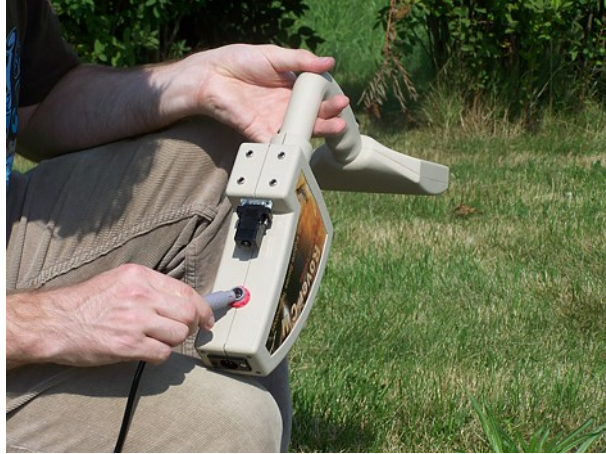
الرسم 6.3: تركيب البطارية الخارجية من أجل التزود بالطاقة
