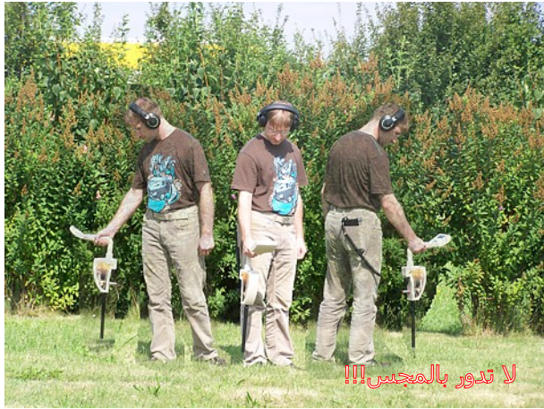
الرسم 7.3: التلويح بالمجس وتدويره يؤثران على صحة نتائج القياس.
