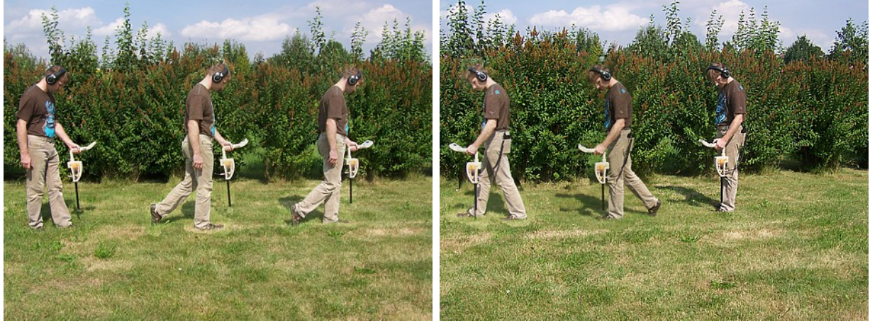
الرسم 7.5 : القياس بشكل متعرج في نمط التشغيل "المسح الضوئي"
