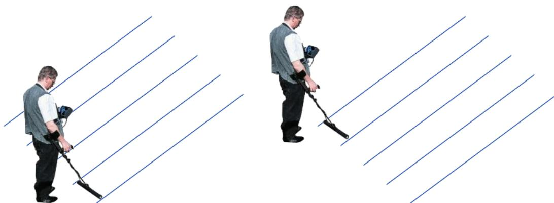
Abbildung 43: Messung mit der Horizontalsonde
