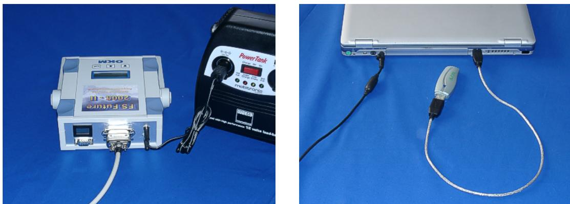
Abbildung 3: Anschluß von externer Stromversorgung und USB-Dongle
