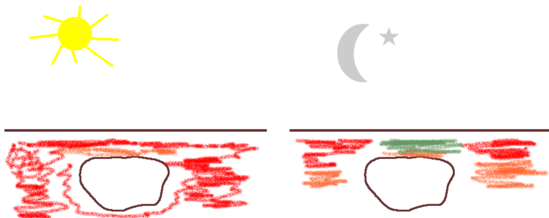
Abbildung 4: Schema der Wärmeverteilung bei Hohlräumen
